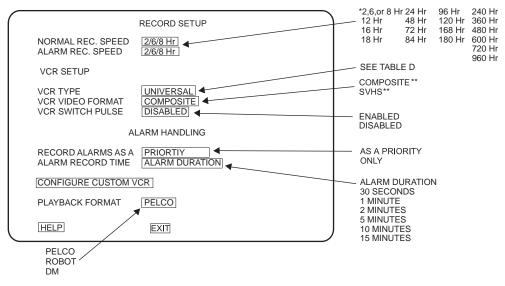
\* 2/6/8 HR FOR NTSC/EIA MODEL MULTIPLEXERS, 3 HOUR FOR PAL/CCIR MODELS. REMAINING RECORD SPEEDS DEPEND UPON VCR MODEL. \*\* NOT SHOWN ON MONOCHROME MODELS.
